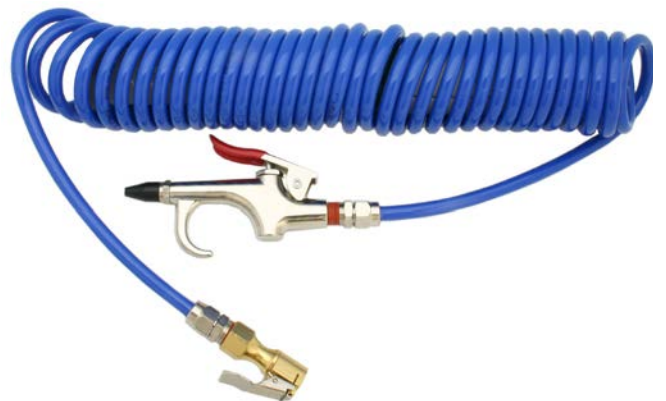
LAR-EPs PISTOLA DE SOPLADO LAR-3020 CON ESPIRAL DE POLIURETANO DE Ø 5 mm x 8 mm x 6 metros DE LONGITUD CON CONECTOR CLIP A VÁLVULA PARA CABINA DE VEHÍCULOS INDUSTRIALES.
