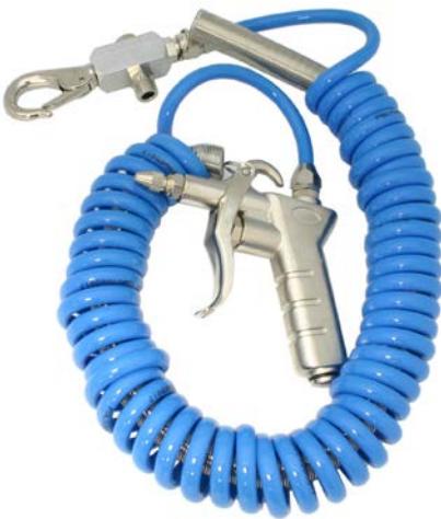
LAR-034516 PISTOLA DE SOPLADO CON CUERPO DE ALUMINIO CON REGULACIÓN DE CAUDAL DE AIRE Y ESPIRAL DE POLIURETANO DE Ø 5 mm x 8 mm x 6 metros DE LONGITUD. CON MUELLE TENSOR INCORPORADO Y GANCHO DE SUJECIÓN. IDÓNEO PARA CADENAS DE MONTAJE ROSCA 1/4
